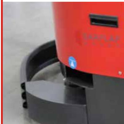
Protecciones de seguridad para el parodo de emergencia
