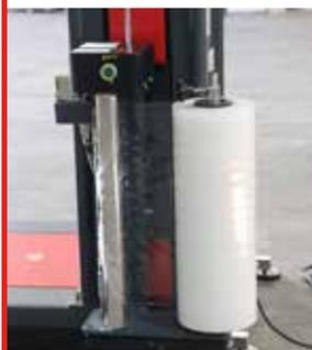
Freno mecánico ajustable con sistema antiatrapamiento (de serie)
