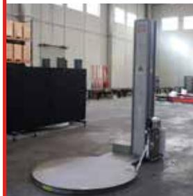
Máquina fabricada en acero INOX 304 para ambientes corrosivos
