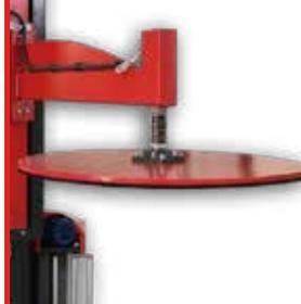
Máquina con prensor motorizado para cargas ligeras o inestables.
