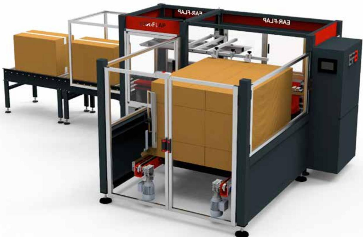
Formadora de cajas automática modelo BEM300 de salida izquierda con almacén de cajas horizontal motorizado + Transportadores de rodillos motorizados de salida
