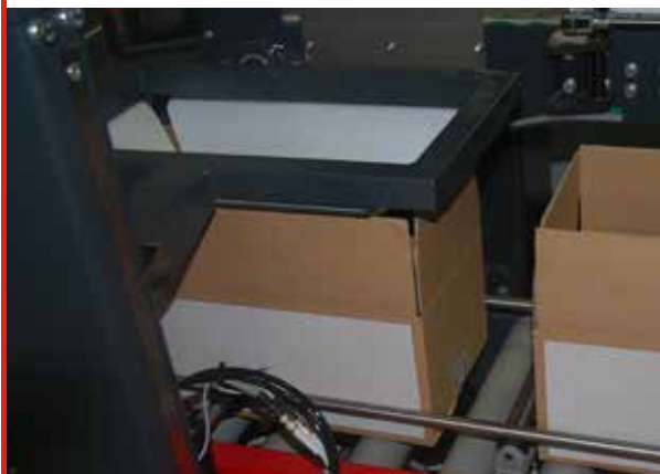
Pórtico abridor solapas
