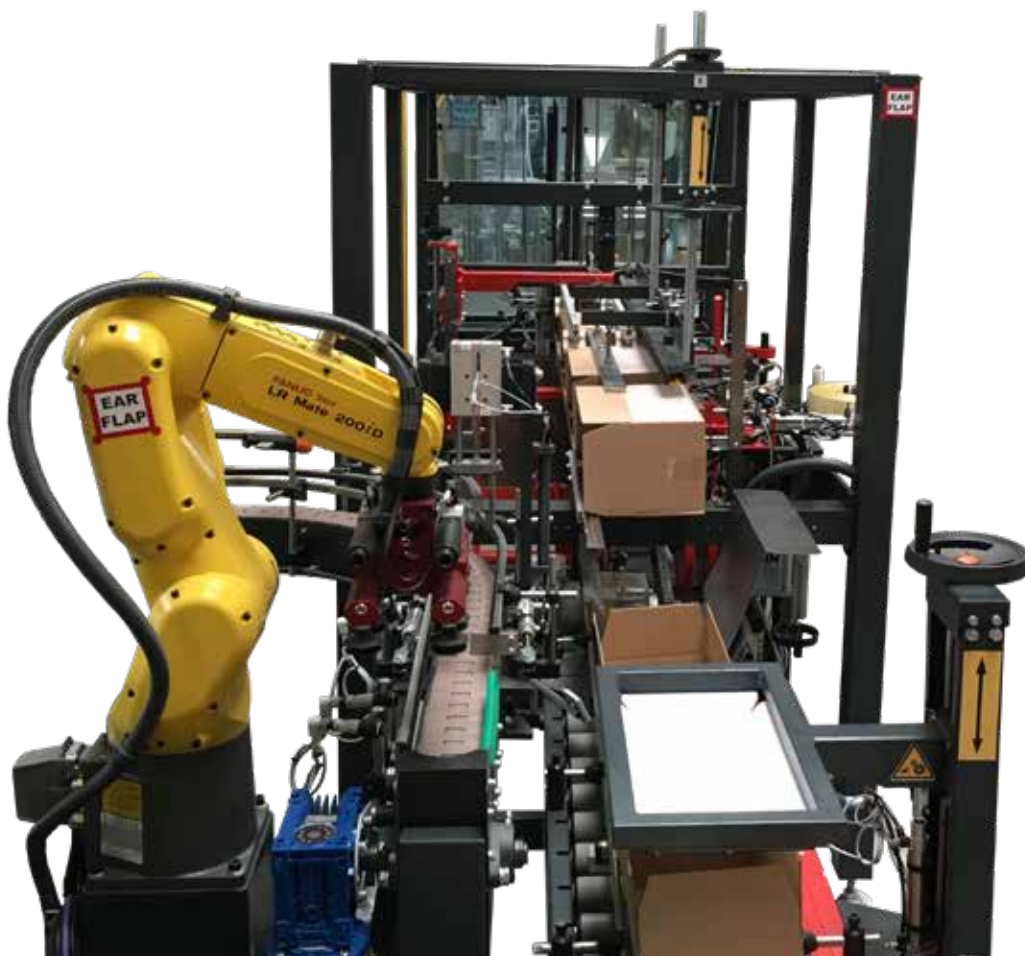
Línea con BEM 400 y encajado con robot Pick and Place
