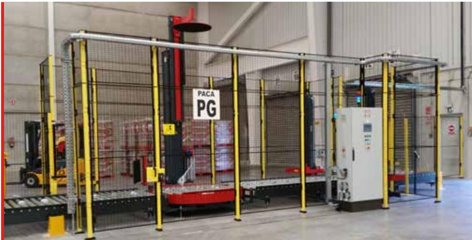
TRM500 con transportador de rodillos motorizados y prensor
