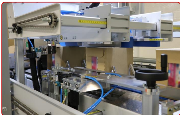
Cierre de solapas externas y escuadrado de caja mediante actuadores neumáticos
