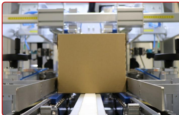
Cierre de solapas externas y escuadrado de caja mediante actuadores neumáticos
